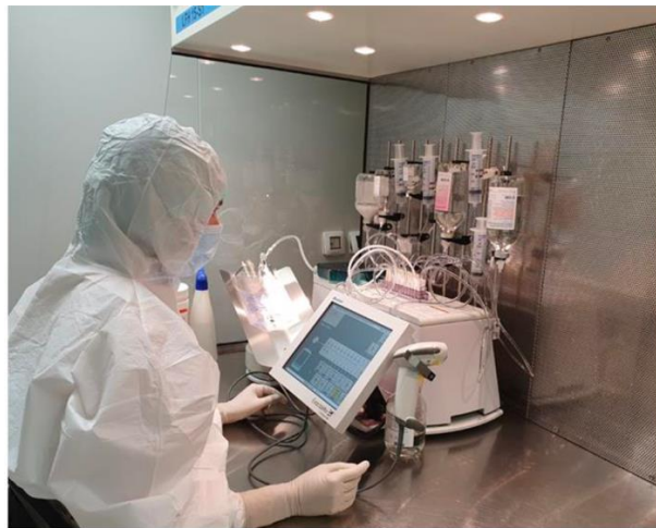
Şekil 4. Laminer hava akışı (LAF) kabiniinde aseptik PN dolumu için otomatik dolum cihazının kullanılması; (Zagreb Çocuk Hastanesi'nin izniyle).
