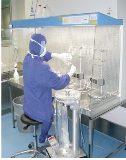
Şekil 4. Laminar hava akımı kabininde vakum ile dolum cihazı kullanılarak aseptik PN karışımı hazırlama
